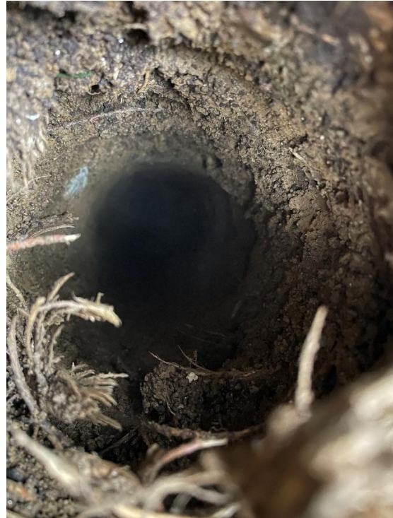
Slika 11: Vrtina za izvedbo ponikovalnega preizkusa
