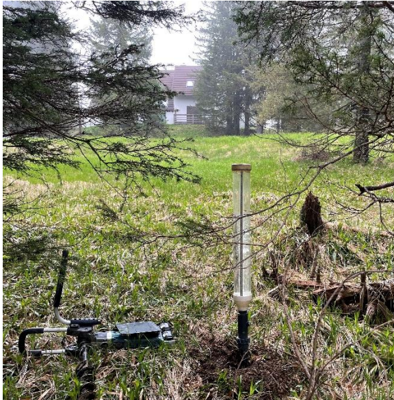
Slika 10: Garnitura za ponikovalni preizkus
